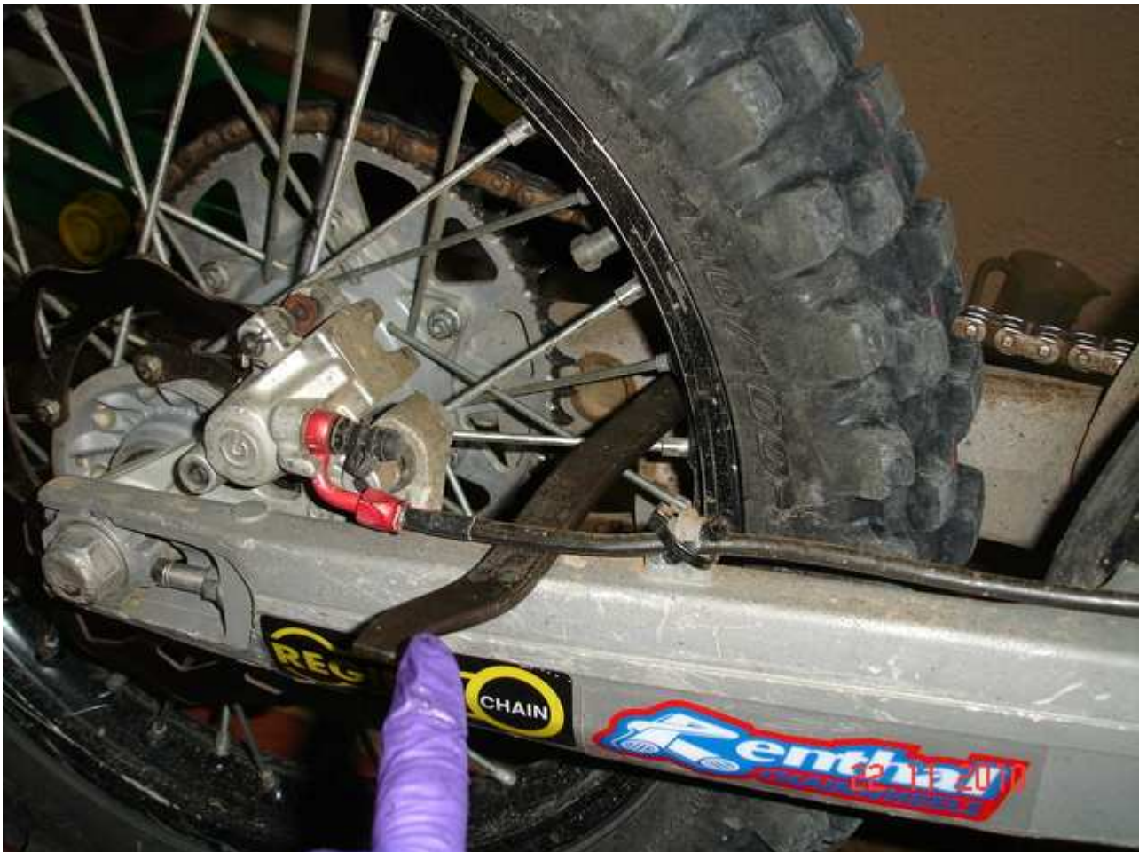
Trabar la rueda con una palanca para poder aflojar tuerca rosca normal:
