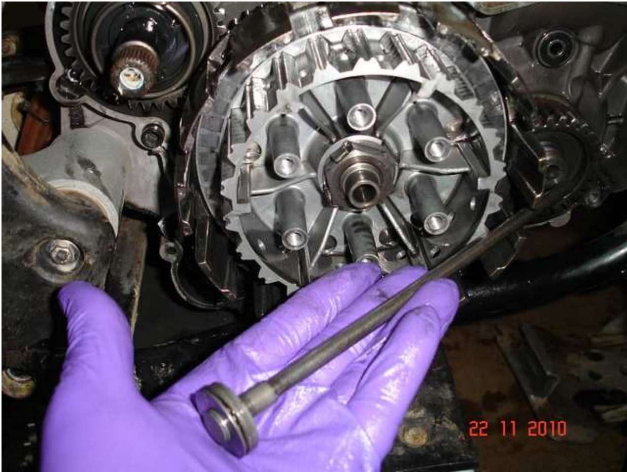
Trabar la rueda con una palanca para poder aflojar tuerca rosca normal:
