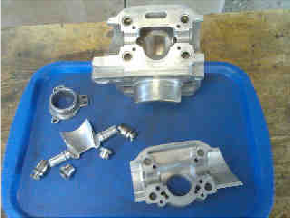
Lo monto todo en su sitio, sustituyo la juntas tóricas y coloco la tapa frontal
